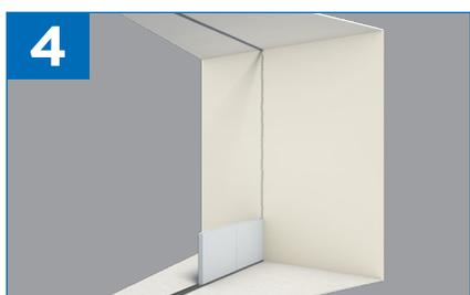
Poursuivez la pose en encollant les tenons (rainures en relief) et les mortaises puis en les emboîtant les uns dans les autres. Serrez fortement les carreaux jusqu'au reflux de la colle.
