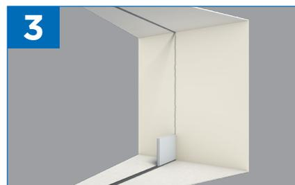
Dépoussiérez et enduisez la mortaise (rainure creuse) du carreau et le mur de départ. Posez le premier carreau dans le U plastique, mortaise vers le bas et poussez-le vers le mur. En pièce humide (cuisine, salle de bains, etc.), utilisez les Caroplatre® Hydro.
