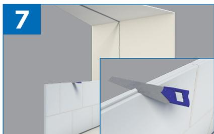
Dans le cas d'une pose avec porte, découpez le tenon venant s'appuyer contre le montant. Fixez la pâte dans le carreau et le montant
