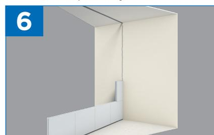
Montez la 2e rangée en commençant par un demi-carreau, si besoin la 3e avec un carreau plein et ainsi de suite afin de toujours décaler les joints verticaux.
