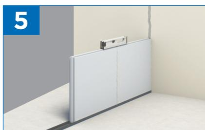
Remplissez de colle le jeu d'1 cm entre le dernier carreau (éventuellement recoupé) et le mur. Enlevez l'excès de colle au couteau après le début de la prise et avant le durcissement de la colle. Evitez surcharges et aspérités. Vérifiez régulièrement l'alignement et la verticalité des carreaux.
