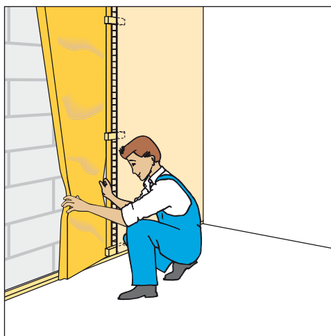
Pose d'une contre-cloison de doublage Placopan®.
