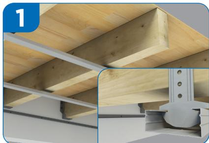
Fixez les cornières Stil® F 530 tous les 60 cm maximum sur les 4 murs à l'aide de fixations adaptées au support. Vissez les suspentes sur la structure existante (1 suspente tous les 60 cm sur une même solive, et tous les 1m20 perpendiculairement à ces solives). Clipsez les fourrures Stil® F 530 dans les têtes des suspentes. Les 2 extrémités de ces fourrures doivent reposer sur les cornières.
