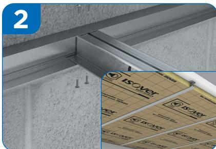
Emboîtez les montants doublés dans les rails et fixez-les à l'aide de 4 vis TRPF (1 vis pour chacune des ailes en haut et en bas). L'entraxe entre les montants dépendra de la portée voulue (voir tableau ci-dessous). Insérez l'isolant plafonds Isover entre les montants.
