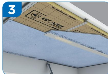
Fixez les plaques de plâtre perpendiculairement aux montants. Vissez-les sur les rails et les montants en commençant par l'angle. 1 vis tous les 30 cm maxi. Réalisez les joints entre les plaques comme expliqué dans l'étape 3 ci-dessus.
