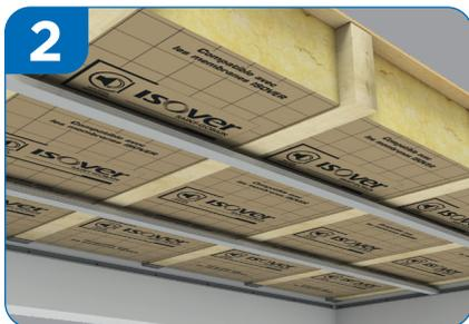
Pour fixer 2 fourrures ensemble, joignez-les à l'aide d'une éclisse Stil® F 530. Insérez l'isolant au dessus des fourrures. Le surfacage kraft est tourné du côté chaud (en général intérieur de la maison).
