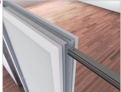
Mise en place du rail coulissant dans la traverse du châssis.
