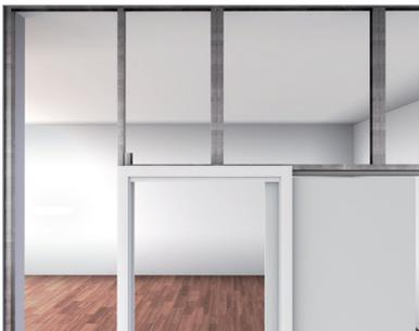
Mise en place des deux montants doublés dos à dos en imposte.
