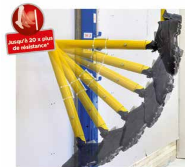
(*) Une résistance aux chocs jusqu'à 20 fois supérieure en double parement Habito® par rapport à un parpaing creux enduit.
