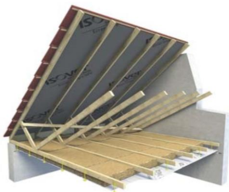
Figure 2.3 : Pose de la membrane pare-vapeur
