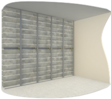
Figure 3-1 : Pose de l'ossature métallique Optima (Lisses, Fourrures, Rallonges et appuis Optima)
