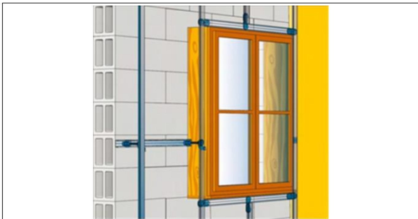
Figure 4 – Mise en œuvre des menuiseries extérieures sur contre-cloison (liaisons solidarisées par des connecteurs Stil® F 530)
