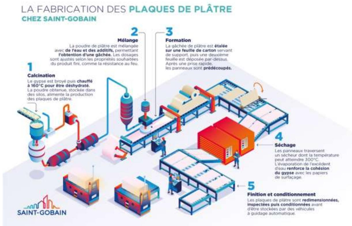
Remarque : Ce schéma ne fait pas figurer l'étape de perforation des plafonds dans l'usine (atelier séparé).
