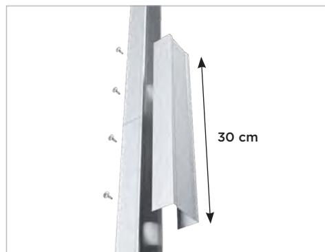
Raccordez-les avec un rail de 30 cm (recouvrement d'au moins 15 cm de chaque côté). Solidarisez le rail par vissage sur les 2 ailes (8 vis TRPF).
