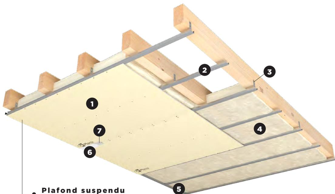
**Plafond suspendu avec suspentes et fourrures Stil® F 530**
