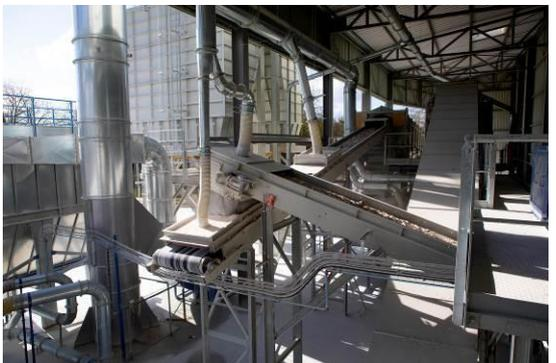
Les deux étapes de broyage et criblage permettent d'**épurer totalement le gypse et d'en extraire les dernières traces de matériaux indésirables** tels que le polystyrène et le carton. Ils sont également triés et renvoyés vers des filières de recyclage parallèles.
